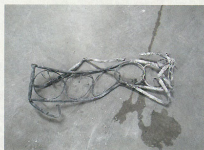
焼却灰の出口から取り出した金属製品 ごみ受け入れへの影響も懸念されます
